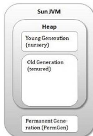
Abbildung 7: Interner Heap Aufbau
