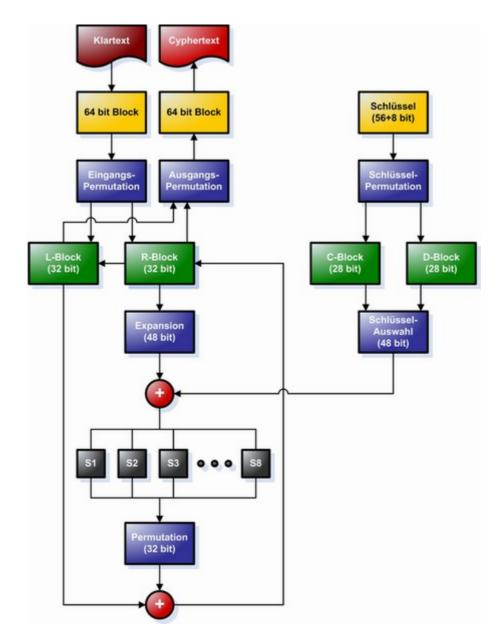
Auf dem Bild oben sieht man die Funktionsweise des DES-Algorithmus. Der Eingangstext von 64 Bit wird wie beim Blowfish in zwei 32 Bit Blöcke unterteilt.
