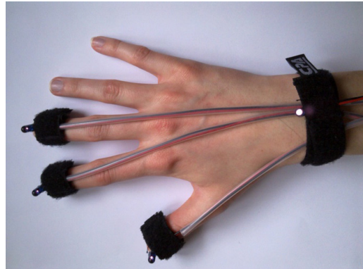
Abbildung 5.1: Vier Infrarot-LEDs als Markierungen für die Handerkennung
