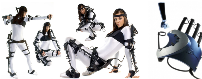
Abbildung 4.5.: Tragbare Anzüge zur Bewegungserfassung. Links: Elektromechanisches Exoskelett 28 . Rechts: P5 Datenhandschuh 29
