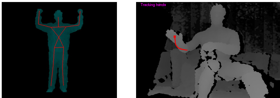
Abbildung 3.10.: Links: Kalibrierungspose unter OpenNI. Rechts: Aktivierte Handverfolgung
