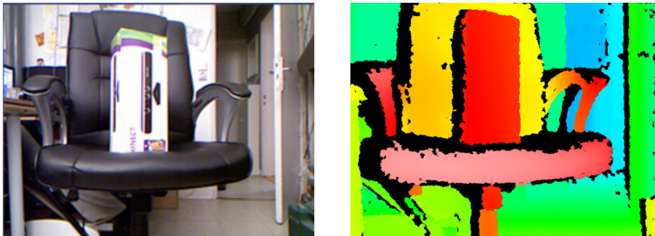
Abbildung 3.8.: Links: Mit Kinect aufgenommenes RGB-Bild. Rechts: Das entsprechende Tiefenbild
