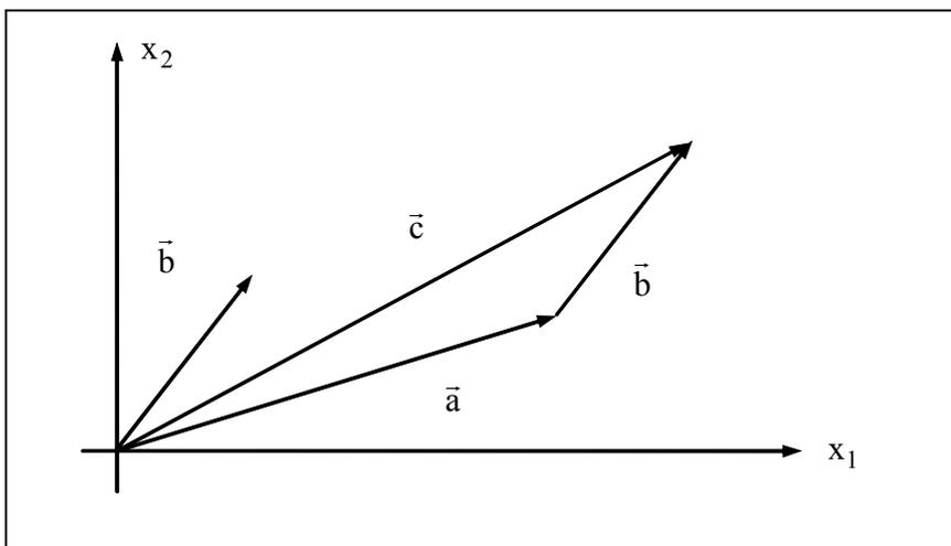
Der Vektor  $\vec{b}$  wird parallel verschoben, so daß sein Anfangspunkt auf den Endpunkt des Vektors  $\vec{a}$  fällt.
