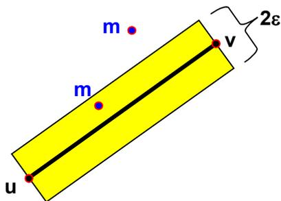
Lösung: (1) Prüfe, ob  $\vec{m}$  sich im durch  $u$  und  $v$  begrenzten Streifen befindet:  $\alpha$  und  $\beta$  müssen spitze Winkel sein, also  $\cos(\alpha) > 0$  und  $\cos(\beta) > 0$ . (2) Das durch  $\vec{a} = \vec{v} - \vec{u}$  und  $\vec{b} = \vec{m} - \vec{u}$  aufgespannte Parallelogramm muss eine kleinere Fläche haben als  $\varepsilon |\vec{v} - \vec{u}|$ , dann liegt  $\vec{m}$  im gelben Rechteck:
