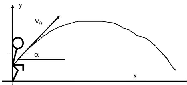
Man bestimme **Flugdauer T** und **Flugweite W**. Für welchen Winkel  $\alpha$  werden Flugdauer bzw. Flugweite maximal? Mit welcher Geschwindigkeit muß ein Springer unter irdischen Bedingungen ( $g = 9.81 \text{ m/s}^2$ ) abspringen, um bei einem Absprungwinkel von  $45^\circ$  eine Weite von 9m zu erreichen?
