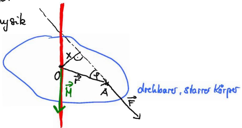
Drehmoment: Kraft  $\times$  Hebelarm
