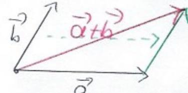
Der Summenvektor lässt sich auch als gerichtete Diagonale im dem aus den Vektoren  $\vec{a}$  und  $\vec{b}$  konstruierten Parallelogramm gewinnen.
