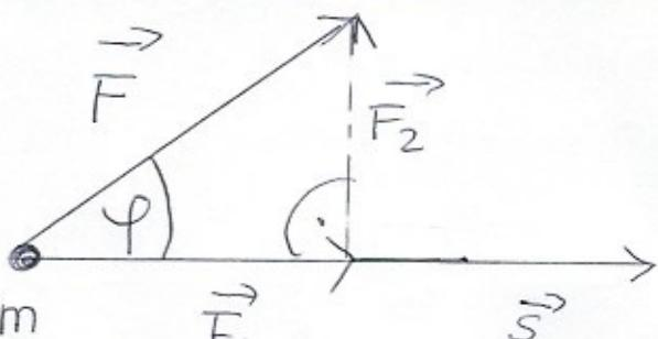
$\vec{F}$  sei eine Kraft, die auf einen Massenpunkt  $m$  wirke.  $m$  bewege sich aufgrund dieser Kraft einwirkung geradlinig in Richtung  $\vec{s}$  auf einer geraden Schiene.
