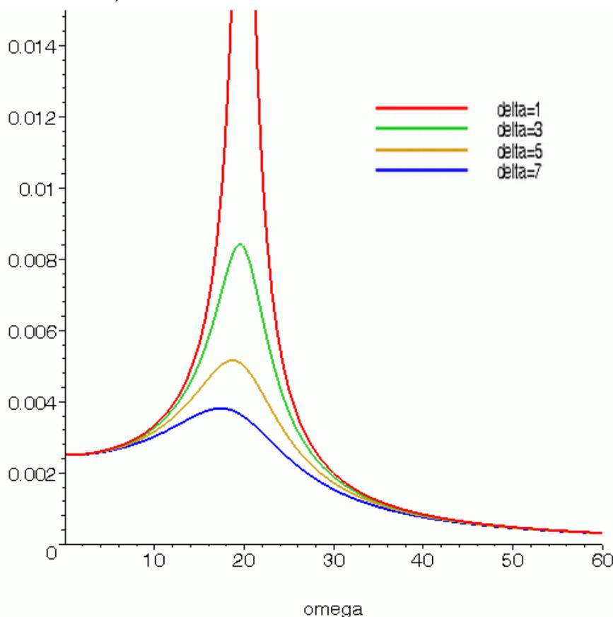
Das Fazit für Bauingenieure und Maschinenbauer: man baue in seine Brücke / seinen Kran geeignete **Dämpfungselemente** ein, sonst wird sie/er einstürzen.
