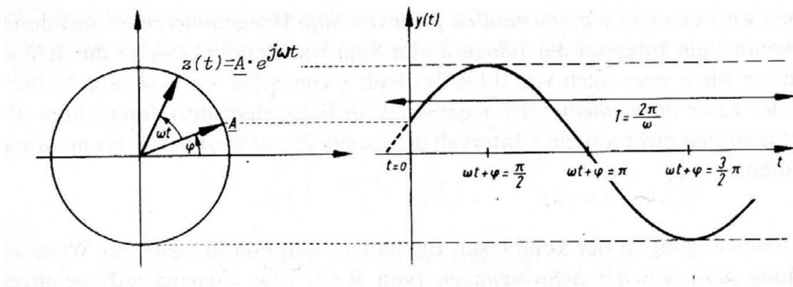
Dreht man den Zeiger einer komplexen Zahl  $z_A = A e^{i\varphi}$  um den Ursprung, so lässt sich das durch  $z(t) = z_A e^{i\omega t} = A e^{i(\omega t + \varphi)}$  beschreiben. Von der Seite betrachtet sehen wir den Imaginärteil  $y(t)$ , der eine sinusförmige Schwingung beschreibt. (Es gilt  $z(t) = x(t) + iy(t)$ .)
