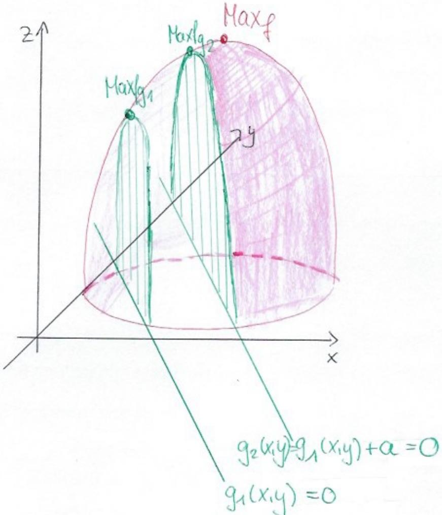
Die Änderung der Nebenbedingung von  $g_1$  nach  $g_2$  bewirkt eine Änderung des Maximums von  $\text{Max } f_{g_1}$  nach  $\text{Max } f_{g_2}$ .
