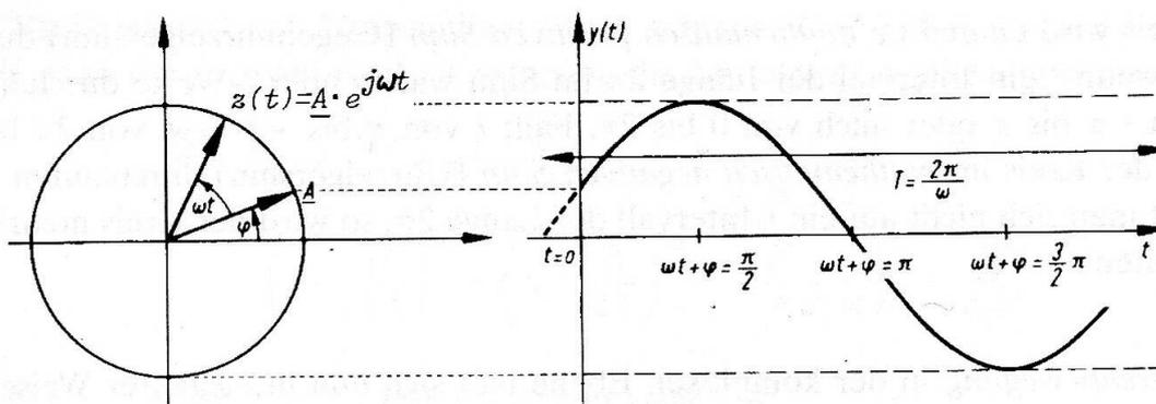
Dreht man den Zeiger einer komplexen Zahl  $Z_A = A e^{i\varphi}$  um den Ursprung, so lässt sich das durch  $Z(t) = Z_A e^{i\omega t} = A e^{i(\omega t + \varphi)}$  beschreiben. Von der Seite betrachtet sehen wir den Imaginärteil  $y(t)$ , der eine sinusförmige Schwingung beschreibt. (Es gilt  $z(t) = x(t) + iy(t)$ .)
