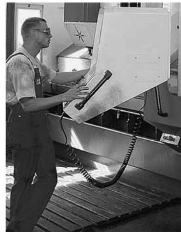
An diesem den Vorschriften entsprechenden Bearbeitungszentrum darf nur im Normalbetrieb allein gearbeitet werden. Für die Behebung von Störungen, für den Werkzeugwechsel und für Instandhaltungsarbeiten muss eine Sicht- und Rufverbindung zu einer zweiten Person bestehen.
