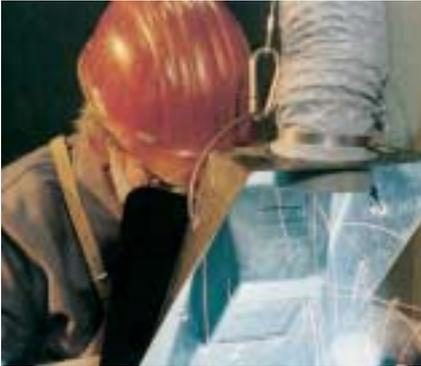
Schweißrauche werden bei im Schutzhelm integrierter Absaugung zwangsläufig erfasst.
