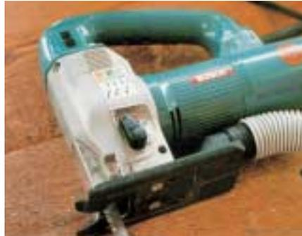
Abgesaugte Stichsäge zur Holzbearbeitung
